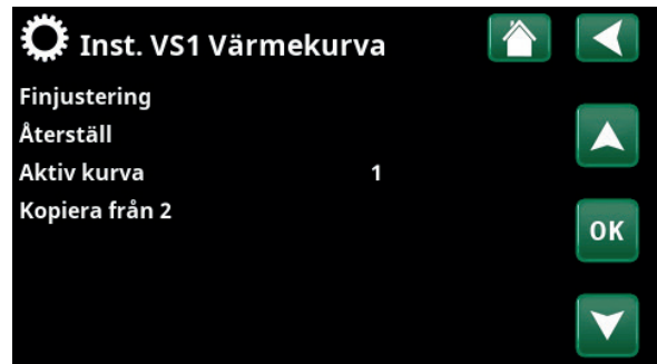
Meny "Avancerat/Inställningar/Värmesystem/Värmesystem 1/Värmekurva".
